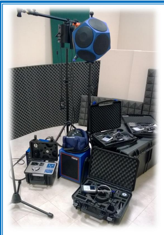
СПЕЦИАЛИЗИРАН МОБИЛЕН ШУМОМЕР СЪС СОФТУЕР И КАЛИБРАТОРИ
