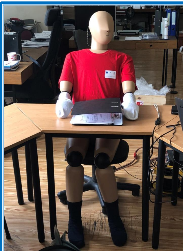
ТОПЛИНЕН МАНЕКЕН ЗА ОЦЕНКА НА ТОПЛИНИЯ КОМФОРТ
