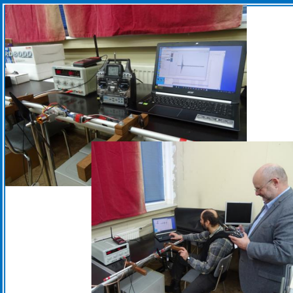
ЕКСПЕРИМЕНТАЛНА УСТАНОВКА ЗА ИЗМЕРВАНЕ НА СИЛИТЕ И МОМЕНТИТЕ НА ВЪЗДУШНИ ВИТЛА НА МАЛКИ БЕЗПИЛОТНИ ЛЕТАТЕЛНИ АПАРАТИ
