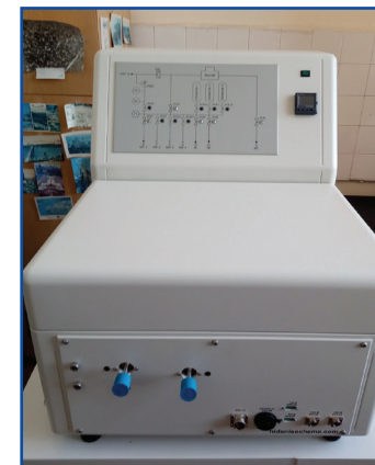
Сивертов апарат за изследване на термодинамиката и кинетиката на водородна сорбция
