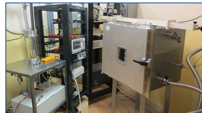
Система за плазмено отлагане на наноструктури и третиране на флуиди
