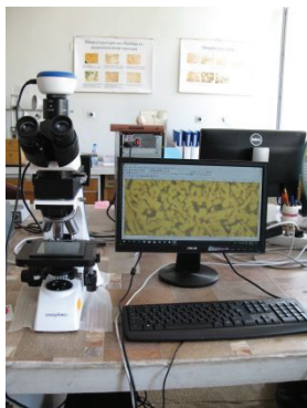
Металографски микроскоп MIT 500 с увеличения до 1000x
