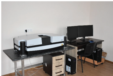
Компютърен рентгенов микротомограф Skyscan 1272, с две работни станции за управление на системата и събиране на данни и за реконструкция и съхранение на изображения
