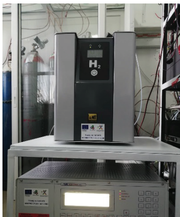
Пламъчно-йонизационен газов анализатор за непрекъснат контрол на общото съдържание на въглеродороди в газова фаза
