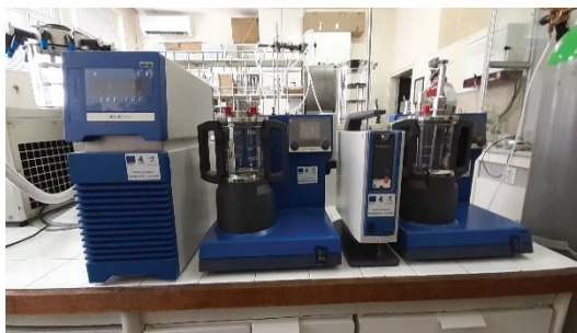
Лабораторна реакторна система с 2 бр. лабораторни реактора за синтез в температурен интервал 5-120 °C с прецизен контрол на температурата, pH на средата и скоростта на разбъркване
