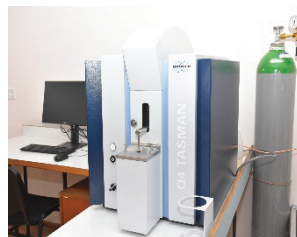
Оптичен емисионен спектрометър за анализ на метали
