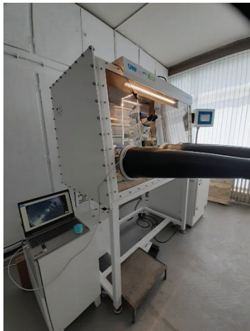
Сух бокс MBraun съдържание на H_2O и O_2 < 0.1 ppm
