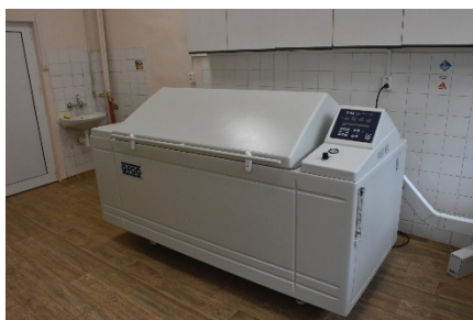
Камера за циклични корозионни изпитвания в солена мъгла
